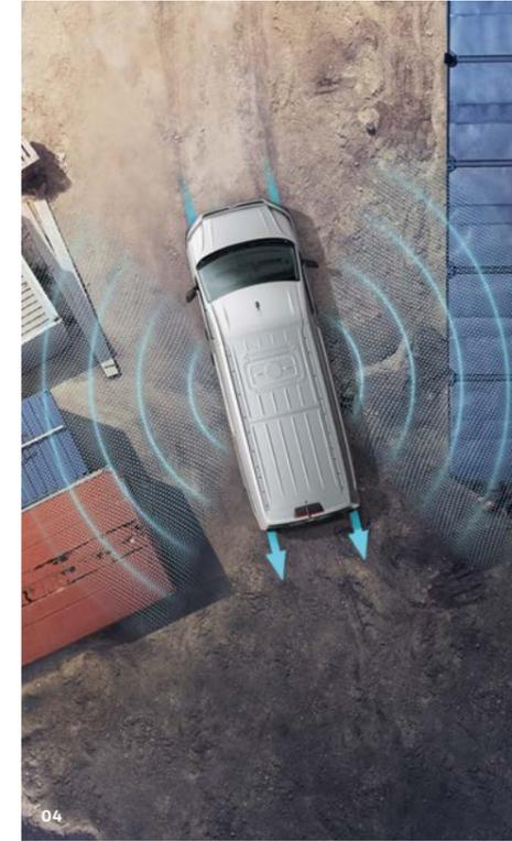
**04 Protección lateral mediante sensores.**<sup>1), 2)</sup> Controla los laterales del vehículo y avisa por medio de señales visuales y acústicas en caso de aproximación excesiva a columnas, paredes o peatones.
