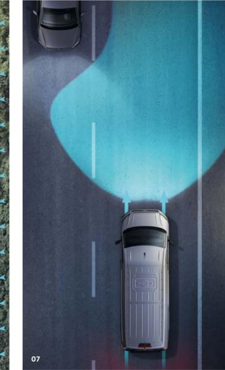
**07 Asistente para luces de carretera "Light Assist".**<sup>2)</sup> Regula automáticamente las luces de carretera cuando detecta vehículos que se aproximan en dirección contraria o vehículos que circulan por delante para no deslumbrar a otros conductores. A partir de 60 km/h y en caso de oscuridad total, las luces de carretera se encienden automáticamente si el sistema se encuentra activado.
