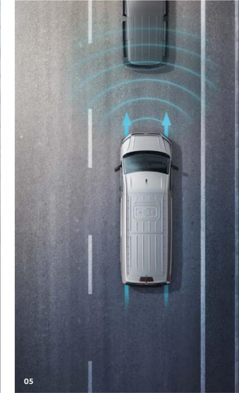
**05 Sistema de observación del entorno "Front Assist" con sistema de frenado de emergencia en ciudad.**<sup>1), 2)</sup> Ayuda a reducir la distancia de frenado del vehículo en situaciones críticas.
